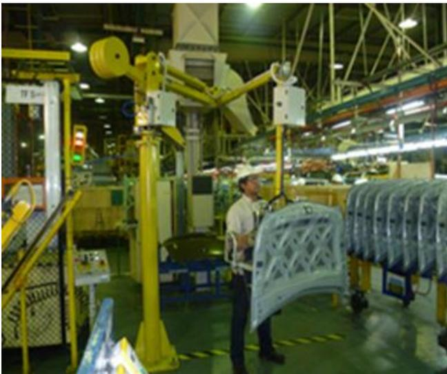
**Figura 35** Manipulador articulado como el Ergo Smart (gentileza de Worktech)
