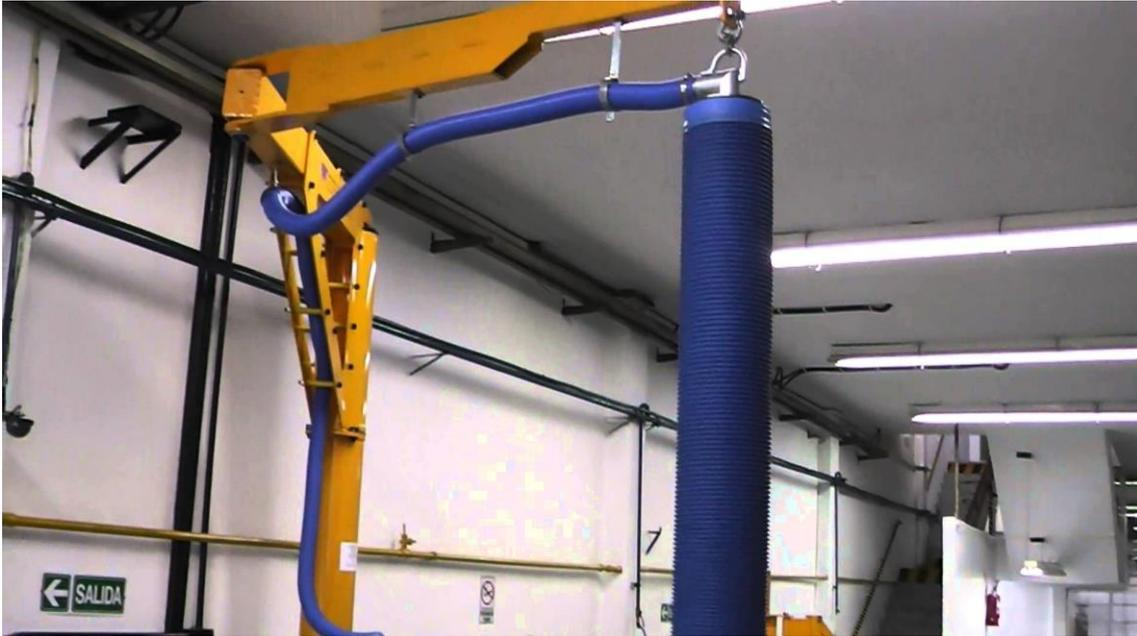
**Figura 32** Asistidor de vacío para levantar bolsas
