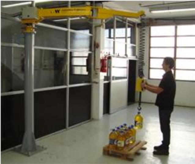
**Figura 34** Manipulador de vacío (vacuom) gentileza de Worktech
