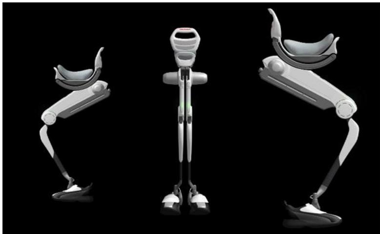
**Figura 6** exoesqueletos para trabajo en cuclillas
