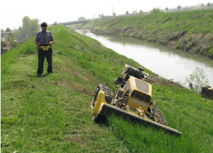
**Figura 47-** Ejemplo de Robot móvil guiado a distancia para desmalezado en autopistas, taludes, etc.
