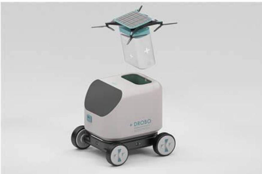
**Figura 53-** dron robotizado para repart0.
