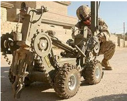
**Figura 52-** Telerobot para detonar un artefacto explosivo enterrado.
