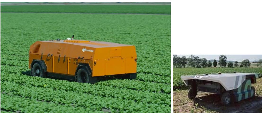
**Figura 48-** Ejemplos de Robot móvil para desmalezado en el campo.
