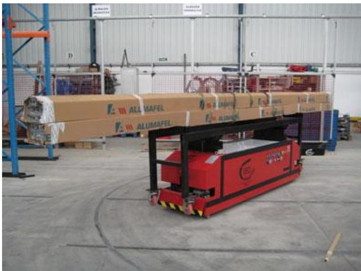
**Figura 44.** Robot móvil por guías en el piso
