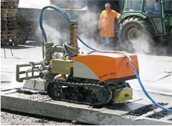
**Figura 49-** Robot guiado remotamente para corte
