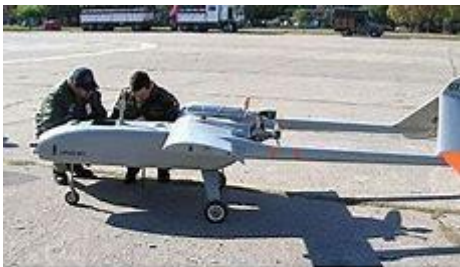
Lipan XM4. Desarrollo entre el INTI - Electrónica e Informática y el Ejército Argentino de mayor alcance y autonomía que el LIPAN III
