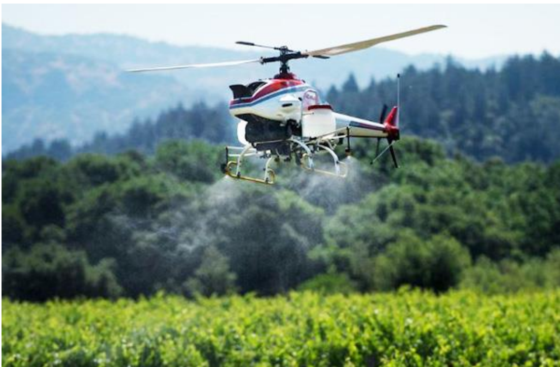
Figura 40. Dron para pulverizar cultivos Yamaha RMAX muy utilizado en Japón
