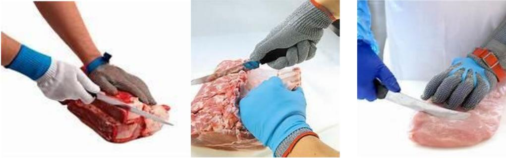
**Figura 55.** Guantes de abrigo, y anti corte usados simultáneamente
