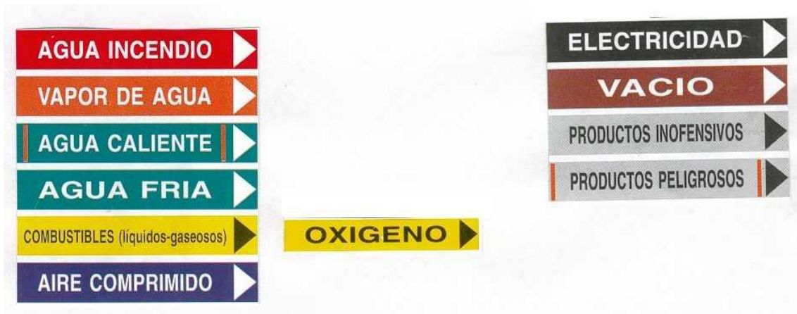
Figura 76. : Colores de identificación de cañerías (firma Produseg. SRL.)
