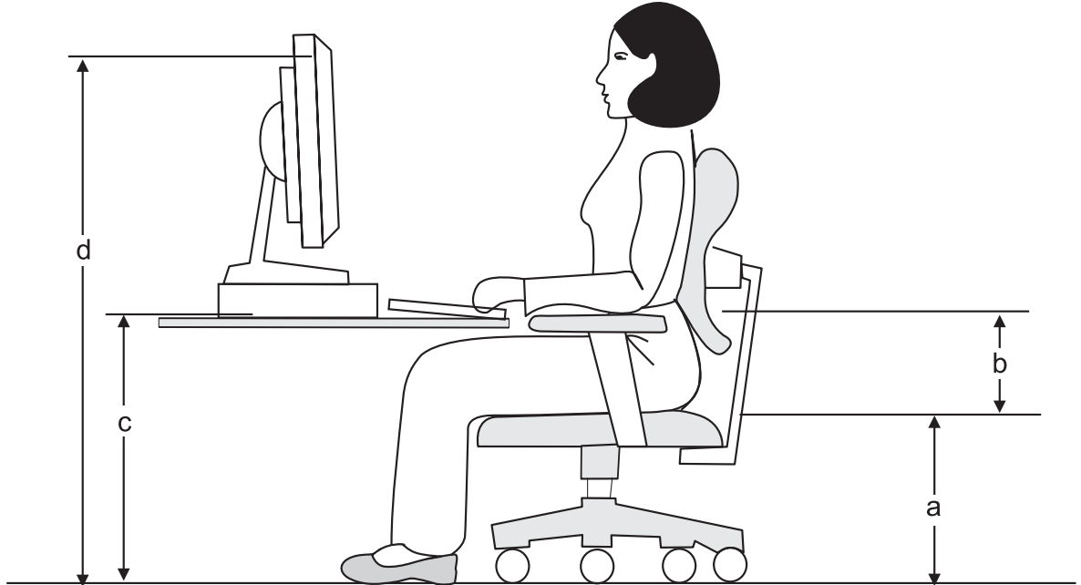
Fig. 6. Simulación bidimensional de la adecuación antropométrica para los valores mínimos del rango de ajuste de a) altura del asiento = 287 mm, b) altura apoya-brazos-asiento = 172 mm, c) altura de la superficie del portateclado = 459 mm, y d) altura del borde superior de la pantalla = 930 mm. Escala 1:10.
